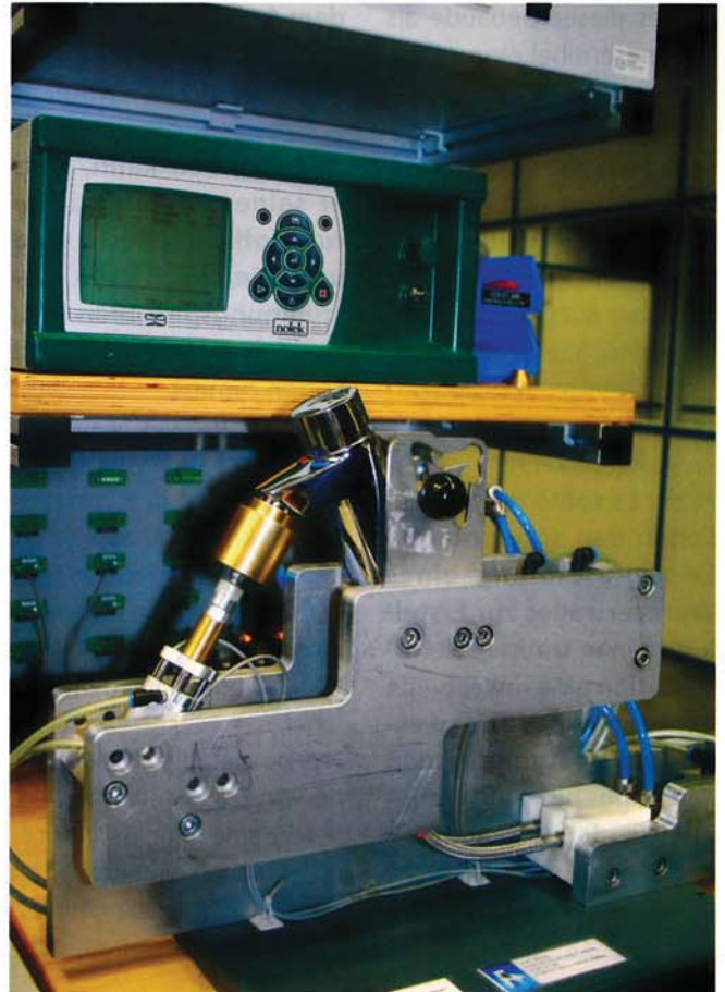
Franke Aquarotter prüft seine Armaturen mit Luft, um eine Kontamination der Innenoberflächen zu vermeiden.
