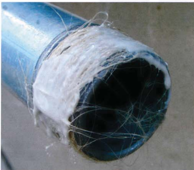
Bioverwertbare Materialien wie Hanf und Dichtungsmittel fördern das Aufwachsen von Biofilmen.
